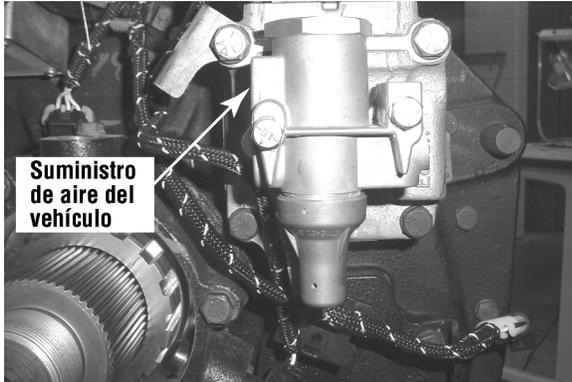
2. Quite los cuatro (2) tornillos de presión de montaje, usando un dado de 7/16".
