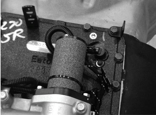
2. Utilizando un dado de 3/8", retire el tornillo de retención del sensor.
