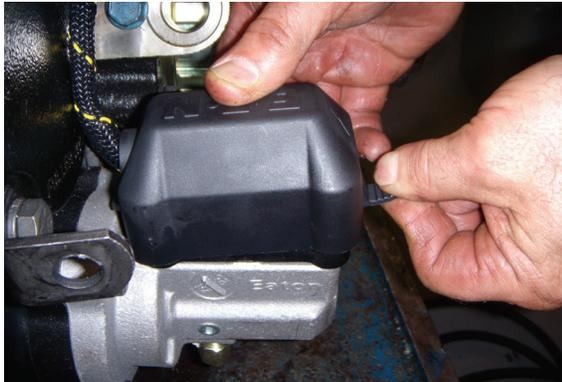
2. Alivie la presión del sistema drenando todos los tanques de aire del vehículo. Cuando haya aliviado la presión, desconecte el arnés de la transmisión de la válvula.
