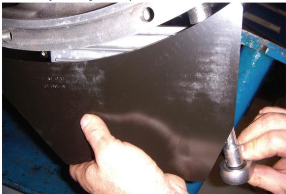
4. Retire los cuatro (4) tornillos de presión de la brida de montaje del ECA.
