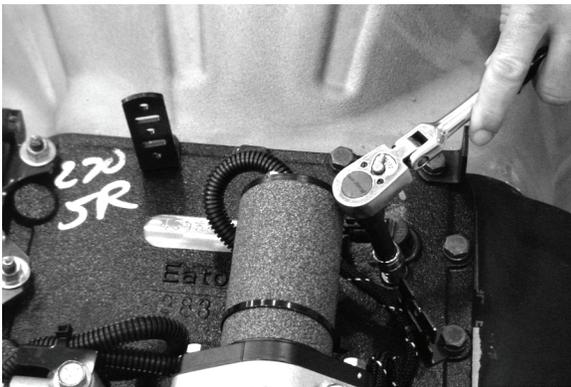
3. Retire el sensor de velocidad de la flecha de entrada, con el anillo "O", de la carcasa de la transmisión.
