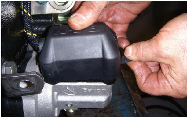
2. Alivie la presión del sistema drenando todos los tanques de aire del vehículo. Cuando haya aliviado la presión, desconecte el arnés de la transmisión del conjunto de la válvula del multiplicador.
