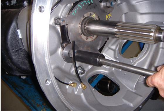
2. Retire el LCIB en forma manual deslizándolo de la flecha de entrada ranurada.
