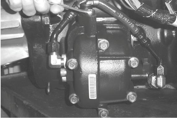
3. Vuelva a conectar el arnés de la transmisión al sensor de velocidad de la flecha de entrada.
