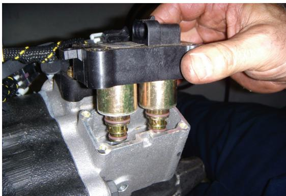
2. Con un dado de 5/16", instale los cuatro (4) tornillos de presión de montaje de la válvula y apriete a 2.3-3.0 N m (21-27 lb pie) utilizando un patrón cruzado.
