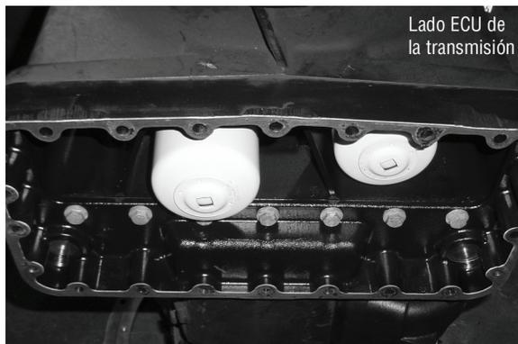
4. Instale una junta nueva y el cárter de aceite del embrague húmedo.
