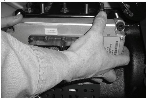
2. Coloque el soporte retenedor del controlador de la transmisión sobre el ECU de la transmisión.
