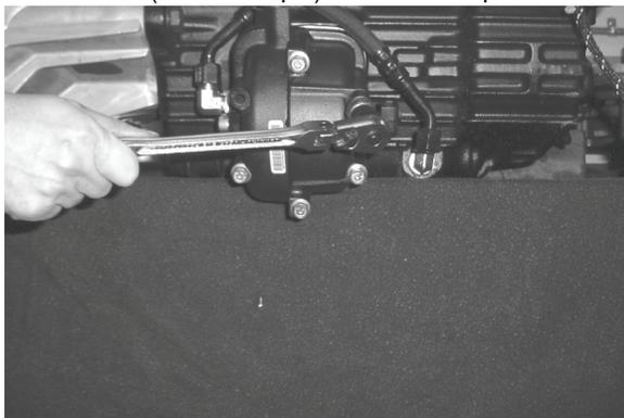
3. Utilizando una llave de 7/8", vuelva a conectar la línea de suministro de lubricante del freno por inercia a la transmisión y apriete a 27-29 N m (20-22 lbs. pie).
