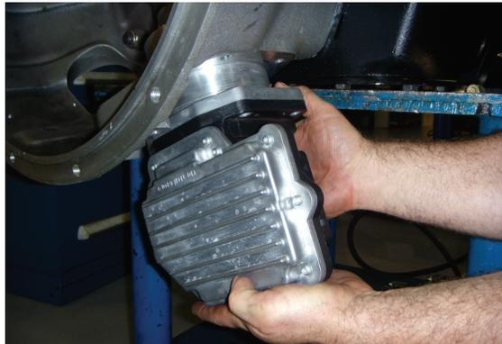
**Nota:** El ECA tiene un pasador de alineación que requiere que la unidad rote para salir del diámetro interior de la carcasa del embrague.
