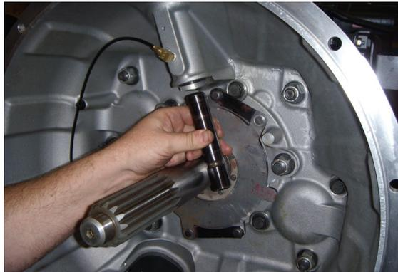
5. Deslice el yugo en el montaje de la flecha transversal superior e instale un (1) tornillo de presión y arandela de seguridad manualmente.
