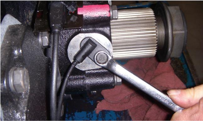
3. Retire el sensor de velocidad de la cubierta del rodamiento trasero de la transmisión.
