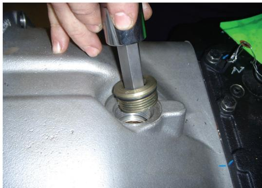
5. De ser necesario, retire el montaje del sello de la flecha transversal superior.
