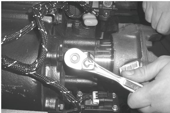
3. Vuelva a conectar el arnés de transmisión al sensor de velocidad de la flecha de salida o a un adaptador, si está equipado.
