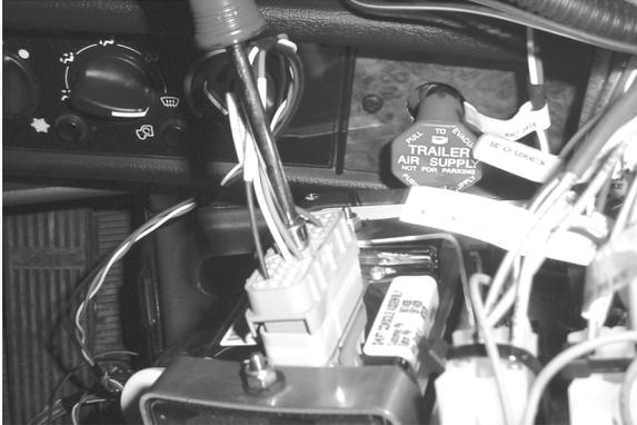
2. Utilizando una llave de 11/32", retire las dos tuercas (2) y arandelas de seguridad de la parte trasera del control de cambios y retírelo
