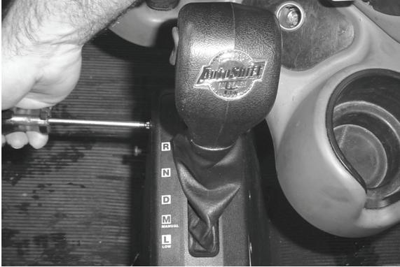
2. Desenchufe el conector de 8 vías del arnés de la palanca Cobra y remueva la palanca Cobra de la carcasa.
