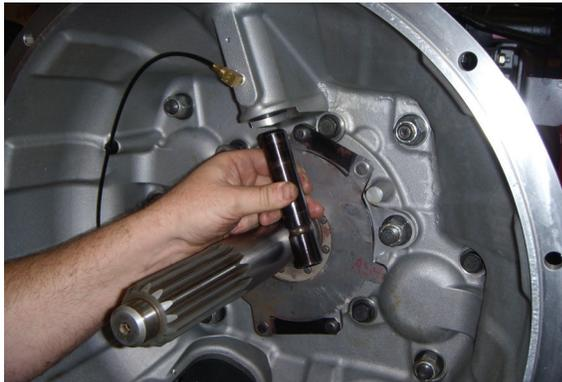
4. De ser necesario, retire el enchufe de flecha transversal con anillo "O".
