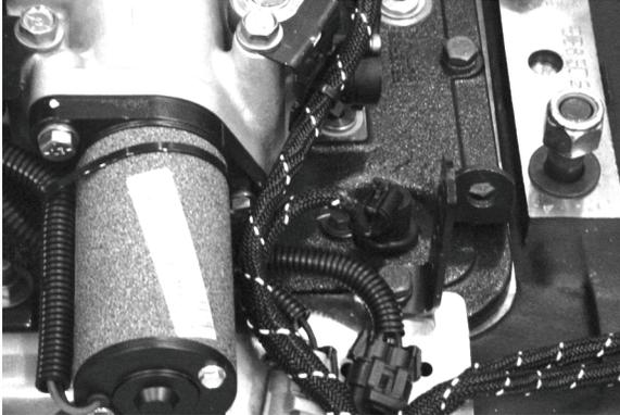
2. Utilizando un dado de 3/8", retire el tornillo de retención del sensor.
