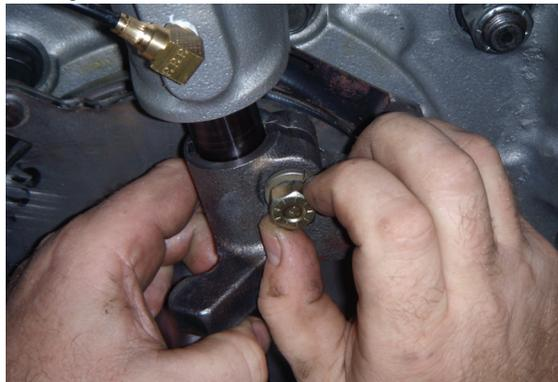
6. Instale el montaje de la flecha transversal superior e instale un (1) tornillo de presión y arandela de seguridad manualmente.
