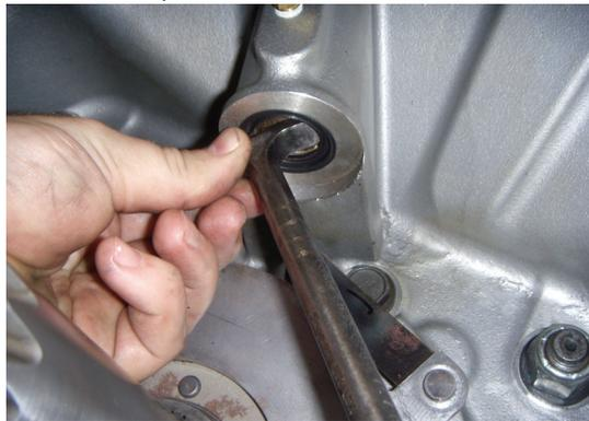
6. De ser necesario, retire los dos (2) bujes de la flecha transversal superior.
