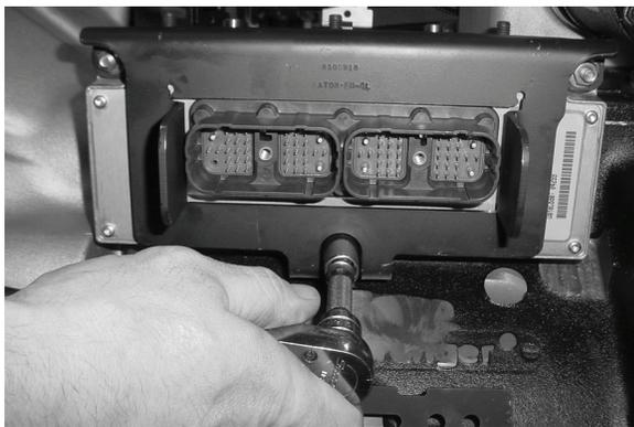
3. Retire el soporte retenedor del controlador de la transmisión.
