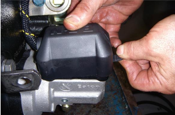
2. Alivie la presión del sistema drenando todos los tanques de aire del vehículo. Cuando haya aliviado la presión, desconecte el arnés de la transmisión de la válvula de rango.
